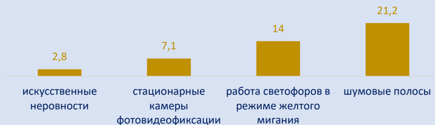
Рис. 6.18. Тяжесть последствий наездов на пешеходов на пешеходных переходах, оборудованных дополнительными техническими средствами организации дорожного движения
