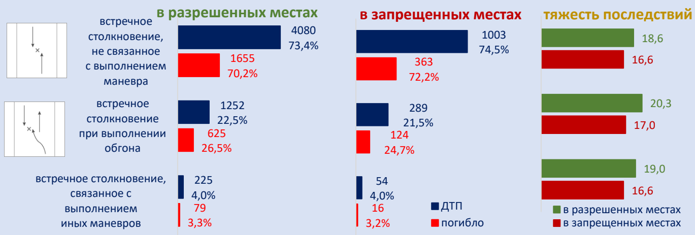
Рис. 3.1.18. Распределение столкновений ТС, связанных с выездом на ПВД на дорогах с двумя полосами движения при движении ТС во встречном направлении, в зависимости от выполняемого маневра
