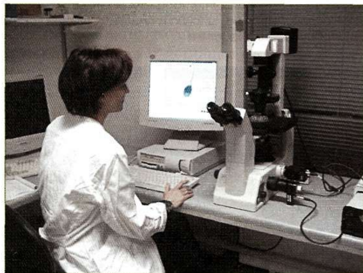
Рис. 66. Анализатор CASA CRISMAS «открытого типа», в основе которого используется принцип анализа треков движения сперматозоидов
