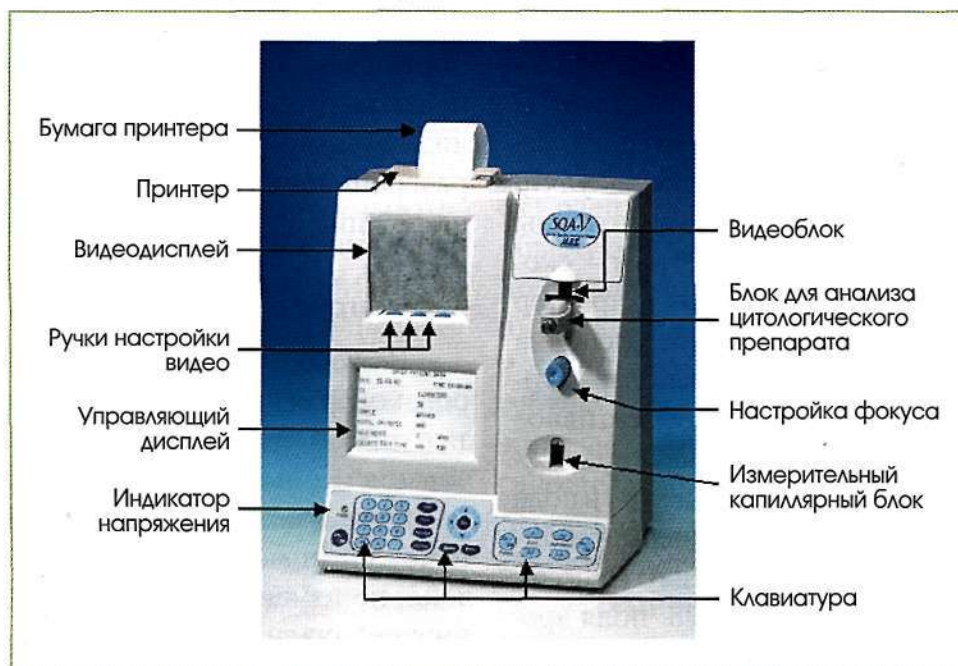
Рис. 50. Автоматический анализатор качества спермы SQA-V
